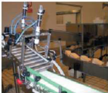
Fig. 5 a e 5b - Al termine della linea i nastri convergenti incanalano gli spicchi a seconda della confezionatrice libera.
